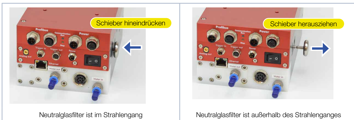
Abb. 22.1: Neutralglasfilter positionieren
